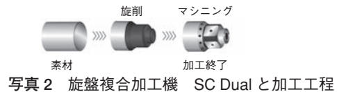
写真2 旋盤複合加工機 SC Dual と加工工程
