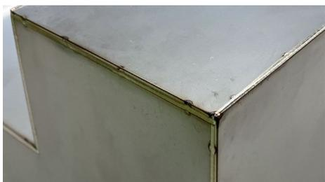
溶接方式：ファイバーレーザー
