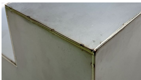
溶接方式：ファイバーレーザー 材質：SUS304 板厚：1.5mm
