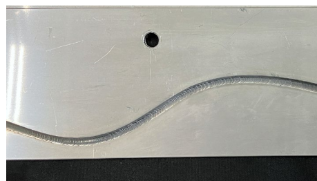
溶接方式：TIG フィラーあり 材質：SUS304 板厚：3.0mm
