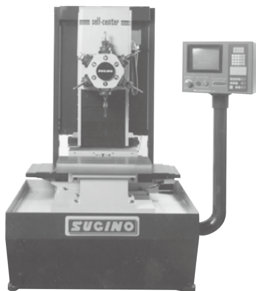
開発したタレット形小型(MC)「セルフセンタ」
