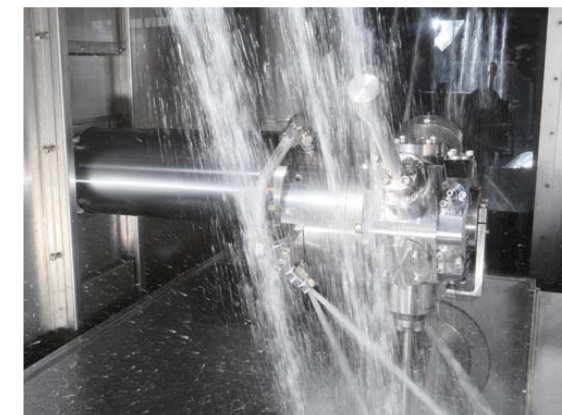
図2 シャワーリング洗浄
