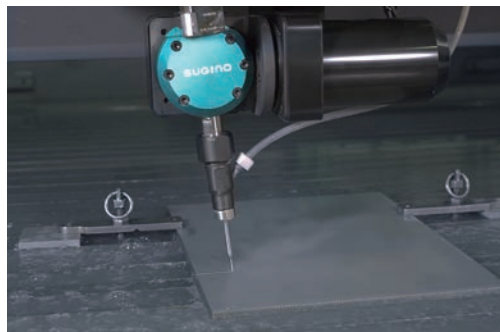
ウォータージェットによる 切断加工の様子
