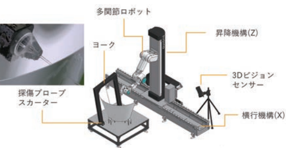
図3 超音波自動探傷システム
